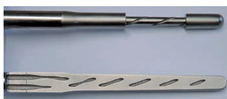
Lasersintereinsätze zeigen ohne PlanoTek KSCN Korrosionserscheinungen (oben)
