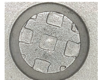
PlanoTek CNBV: Nach über 100 000 Schuss ist die Schicht noch voll funktionsfähig
