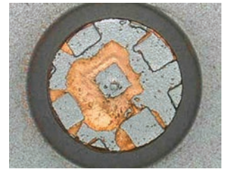
Vergleichsschichten: Nach 80 000 Schuss Ätzstruktur komplett abgetragen
