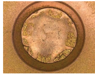
Vergleichsschichten: Nach 80 000 Schuss Ätzstruktur komplett abgetragen
