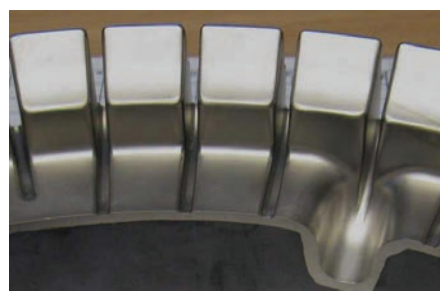
Beschichtete Kupfereinsätze, 20 µm PlanoTek CNBV
